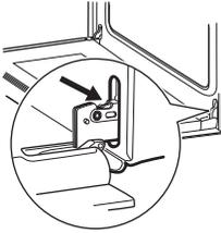
Klappen Sie die Backofentür ganz auf, und greifen Sie an die beiden Türscharniere.
