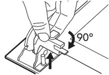
Drehen Sie die beiden Befestigungselemente um 90 Grad und nehmen Sie sie aus der Halterung.
