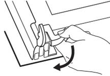
Lösen Sie das Verriegelungssystem, um die Glasscheiben zu entfernen.
