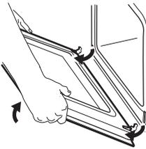
Schließen Sie die Backofentür halb bis zur ersten Raststellung. Anschließend ziehen Sie sie nach vorn aus der Halterung heraus.
