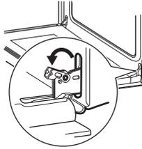
Heben Sie die Hebel der beiden Scharniere an, und klappen Sie sie nach vorn.
